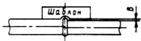
Рис. 11. Схема определения смещения кромок стыкуемых труб
